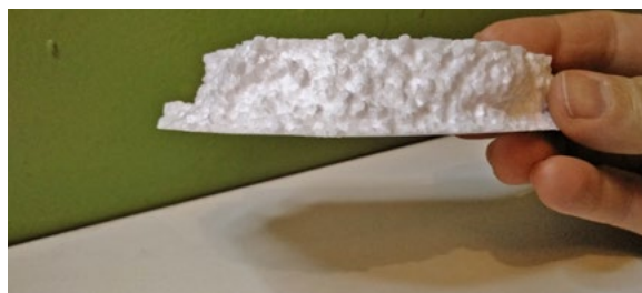
El telgopor es un tipo de plástico que transmite débilmente el calor. Es un aislante térmico.
